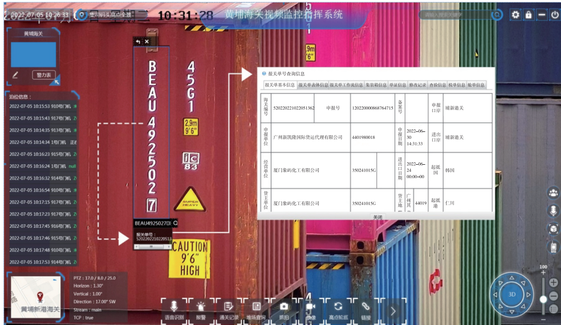
图4 箱号识别关联报关单查询示意图(电子版为彩图)
